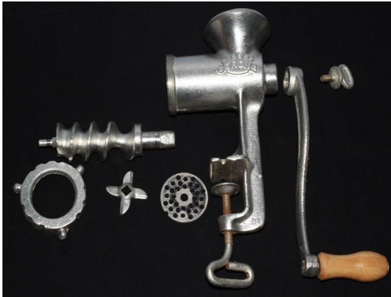
Fotografía N°- 2 Partes de un molino de carne. Fuente: Fotografiado por Javier Pozo 2014.
