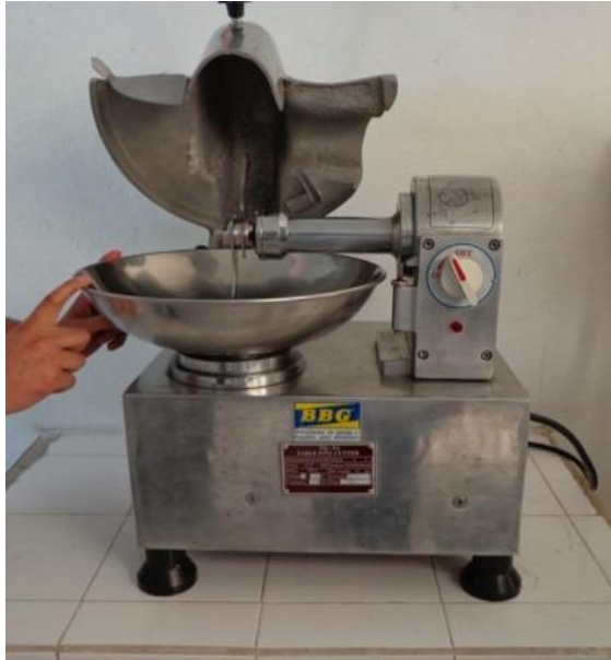
Fotografía N°- 1 Maquina procesadora de carne “cutter”. Fuente: Fotografía tomada por Johana Salazar.
