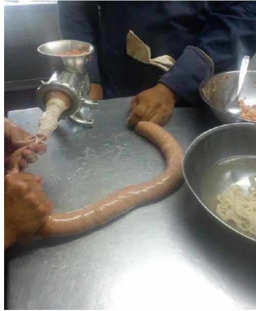
Fotografía N°- 4 Funcionamiento de la embutidora con su adaptador de embudo. Fuente: Fotografiada por Javier Pozo 2013 - 2014.
