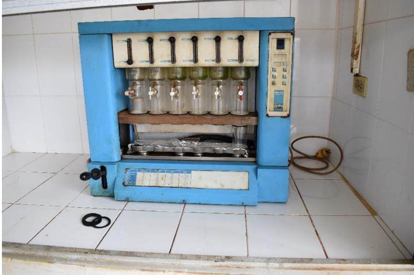
Fotografía 5: Proceso para determinar nivel de grasa en Chicha de jora
