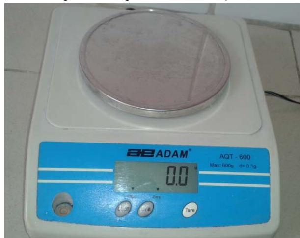
Imagen No. 19. Instrumento de medición de sólidos. Balanza. Fuente: Y. Tupiza. 2015.
