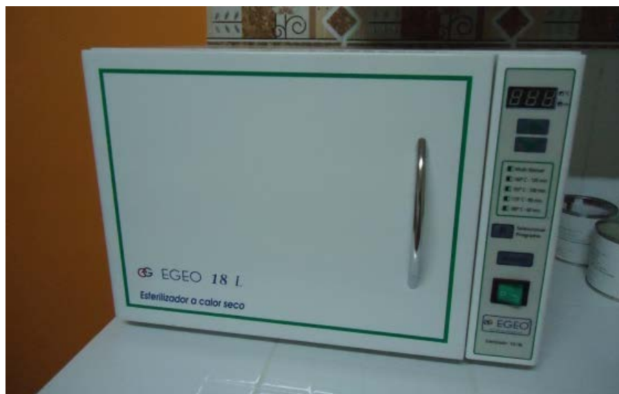
Imagen N° 15. Esterilizador aire caliente.
