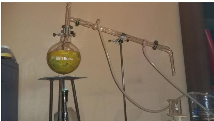
**Imagen No. 19.** Equipo de destilación reestructurado. Fuente: P. Córdova, 2015.
