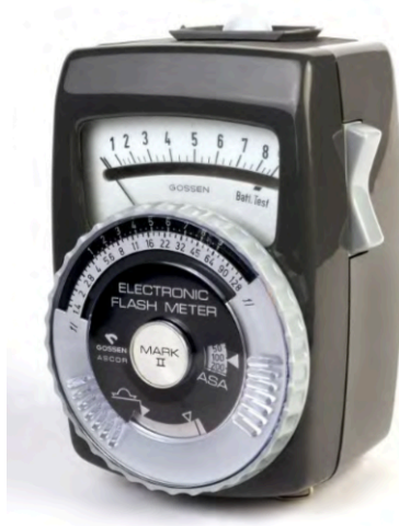
Gráfico 12: Fotómetro Gossen calibrado, Fuente: Catálogo personal Romero (2020)
