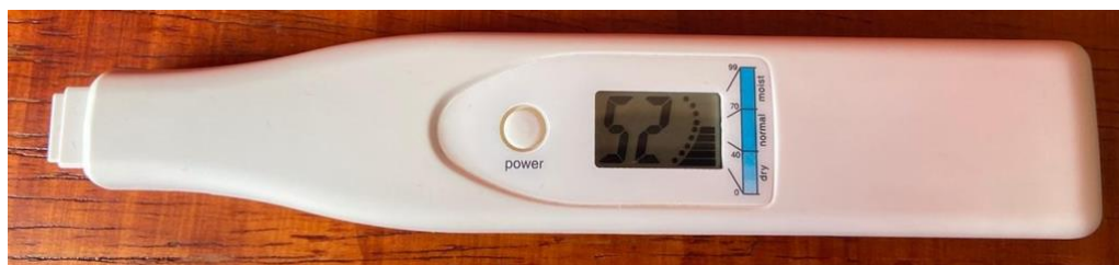
Figura 16. Corneómetro Skin moisture sensor.
