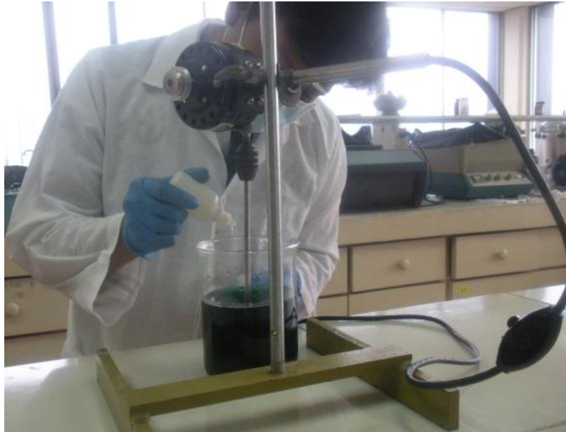
Imagen No.30. Adición de Trietanolamina. Fuente: Mishel Quinto, 2015.
