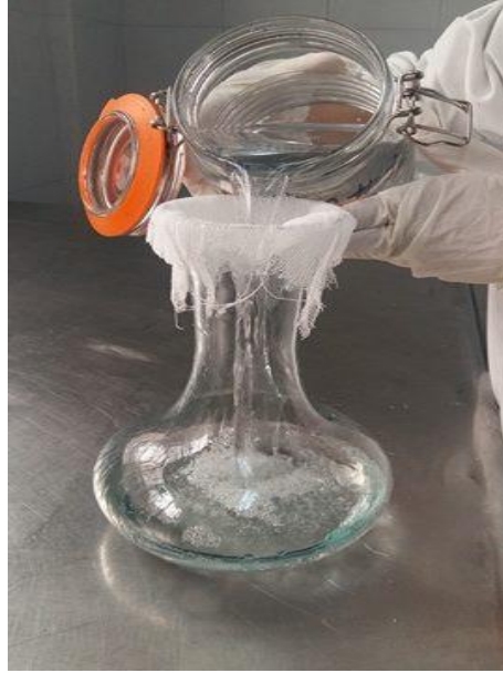
Figura No. 09. Uso del decantador para eliminar impurezas de los licores. Presente investigación.
