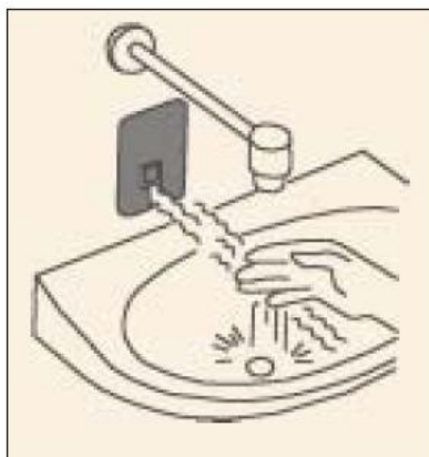
Figura N° 34. Grifo de lavamanos con sensor
