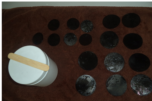
Imagen N.- 26. Aplicacion de gel neutro sobre los electrodos. Fuente: A. Carrión, 2014.
